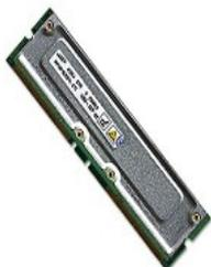
Con il termine **RIMM (Rambus In-line Memory Module)** si identifica un tipo di memoria RAM a 184 pin sviluppata dalla Intel per le proprie piattaforme come Playstation 2 e schede madri.
